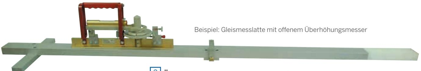
Beispiel: Gleismesslatte mit offenem Überhöhungsmesser
